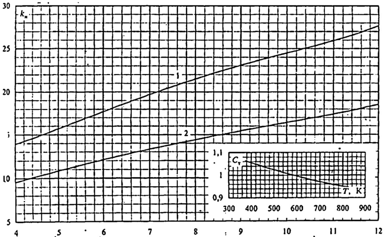
Рисунок 4.7 – Коэффициент теплоотдачи чугунных ребристых экономайзеров: 1 – экономайзер ВТИ и экономайзер из труб с дополнительным продольным оребрением; 2 – экономайзер ЦККБ
