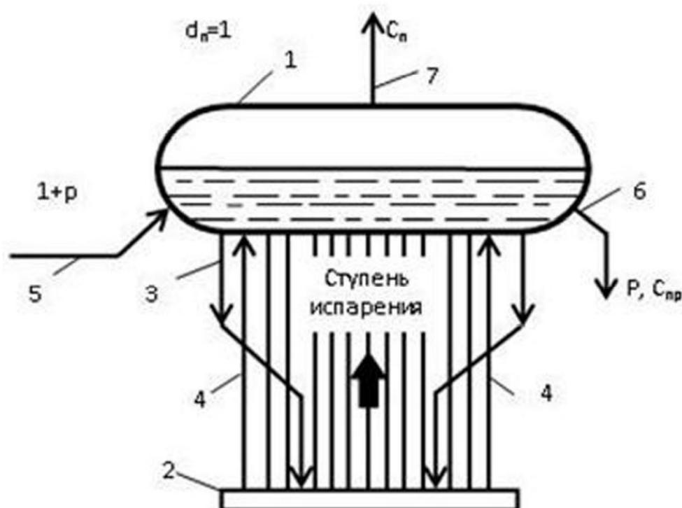
Рисунок 2.9 – Простейшая схема одноступенчатого испарения в барабанном котле:
