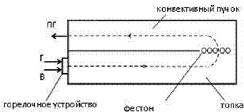
Рисунок 2.7 – Схема движения газов в котлах производительностью 16–25 т/ч
