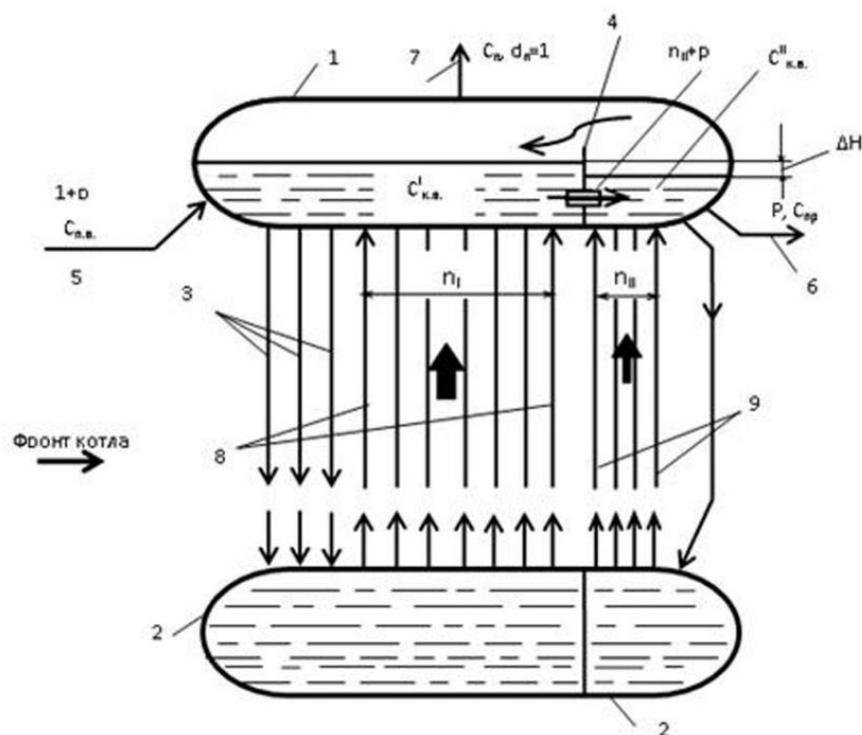
Рисунок 2.11 – Двухступенчатая схема испарения котлов ДЕ
