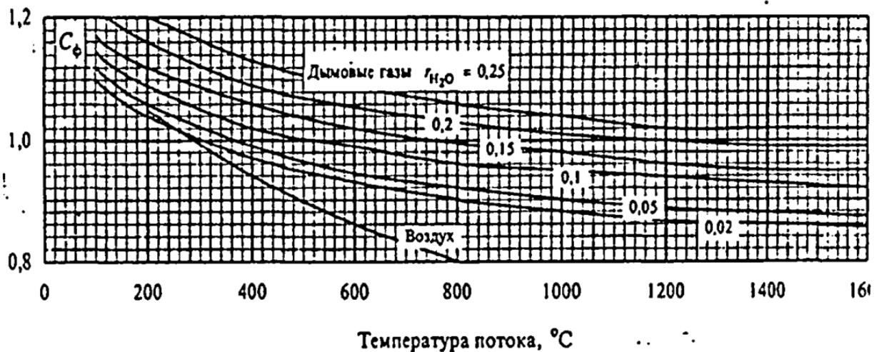
Рисунок 4.2 – Номограмма для определения поправки на влияние физических параметров среды  $C_{\phi}$
