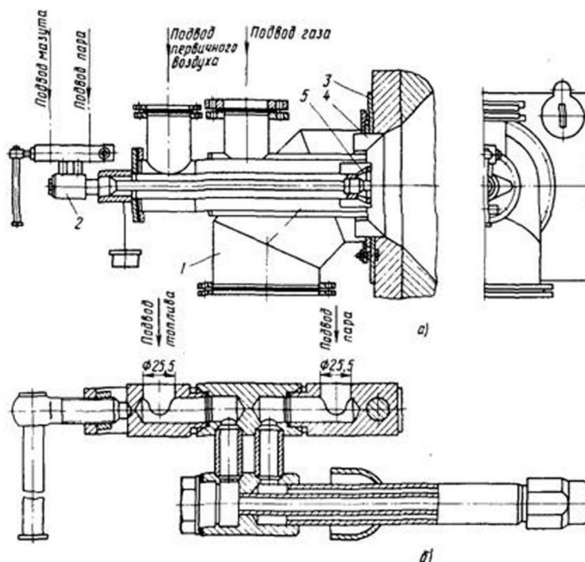
Рисунок 2.5 – Горелочное устройство типа ГМГ:
