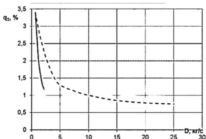
Рисунок 4.1 – Потери тепла от наружного охлаждения  $q_5$
