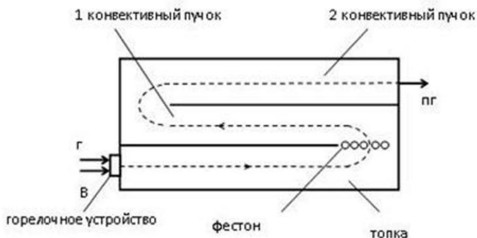
Рисунок 2.6 – Схема движения газов в котлах производительностью 4; 6,5 и 10 т/час
