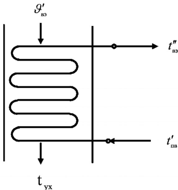
Рисунок 4.6 – Расчётная схема водяного экономайзера второй ступени
