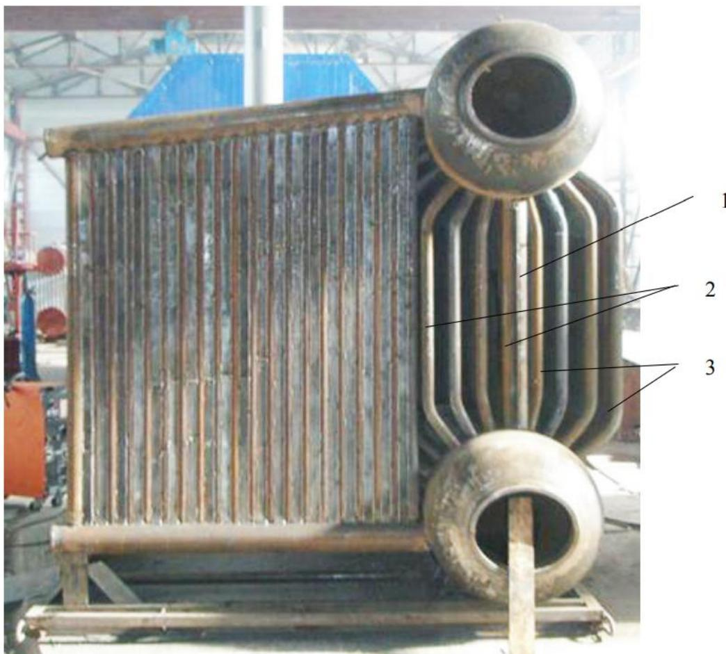
Рисунок 2.14 – Трубная система котла типа ДЕ производительностью 4–10 т/ч
