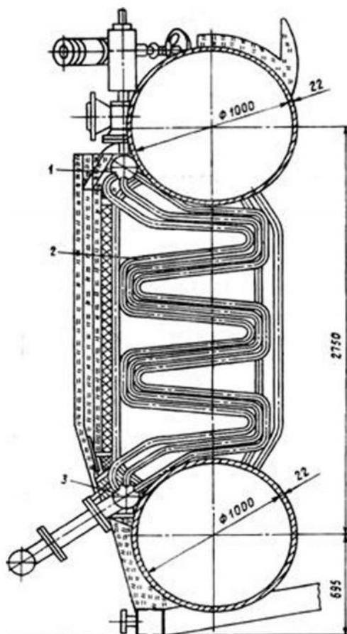
Рисунок 2.4 – Змеевиковый пароперегреватель котлов типа ДЕ:
