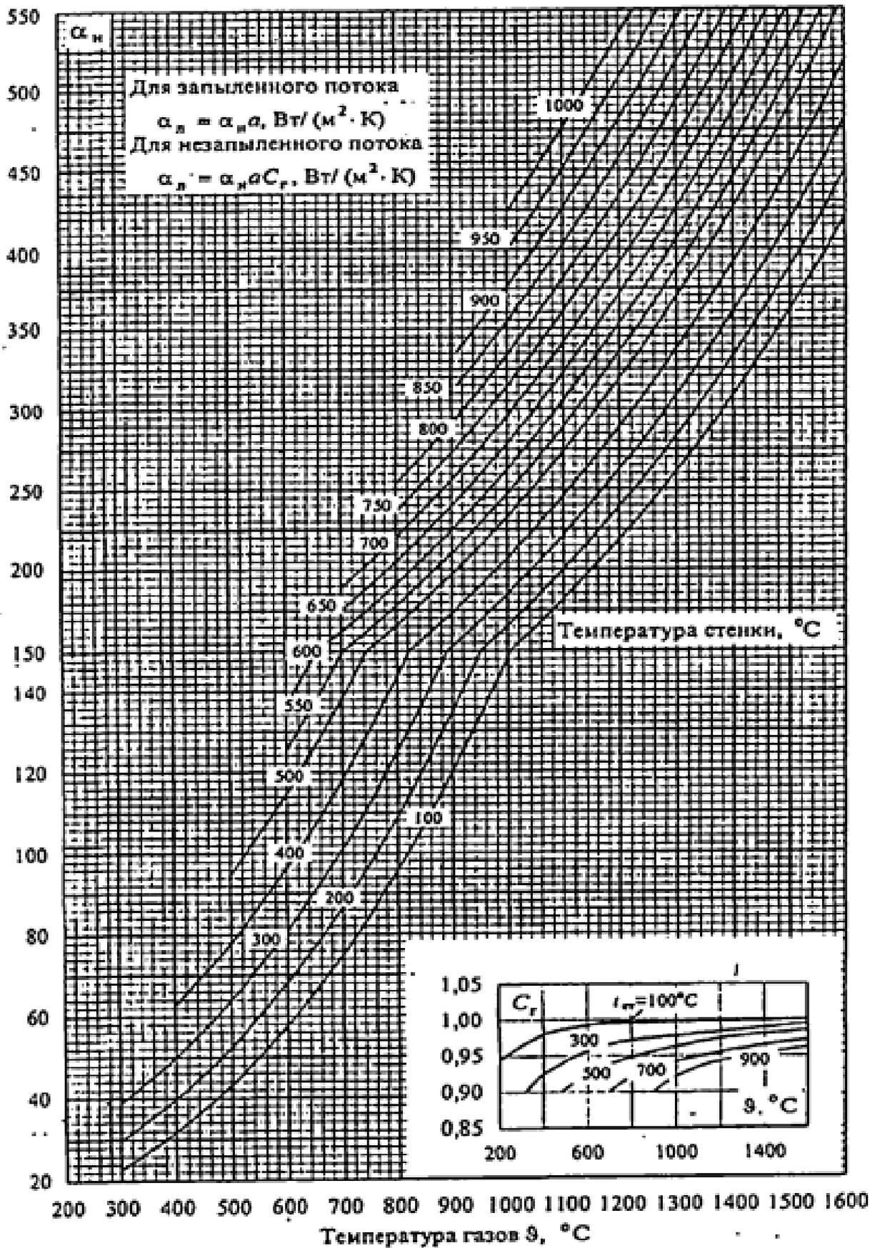
Рисунок 4.5 – Коэффициент теплоотдачи излучением
