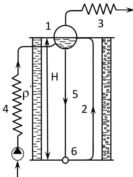
Рисунок 2.13 – Схема циркуляционного контура котла:
