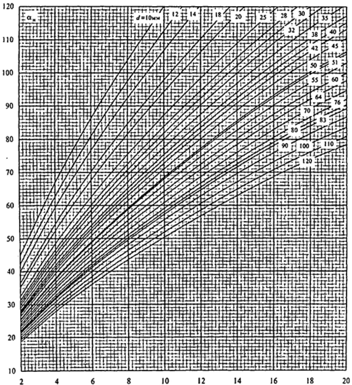
Рисунок 4.3 – Номограмма для коэффициента теплоотдачи конвекцией при поперечном омывании коридорных гладкотрубных пучков и ширм
