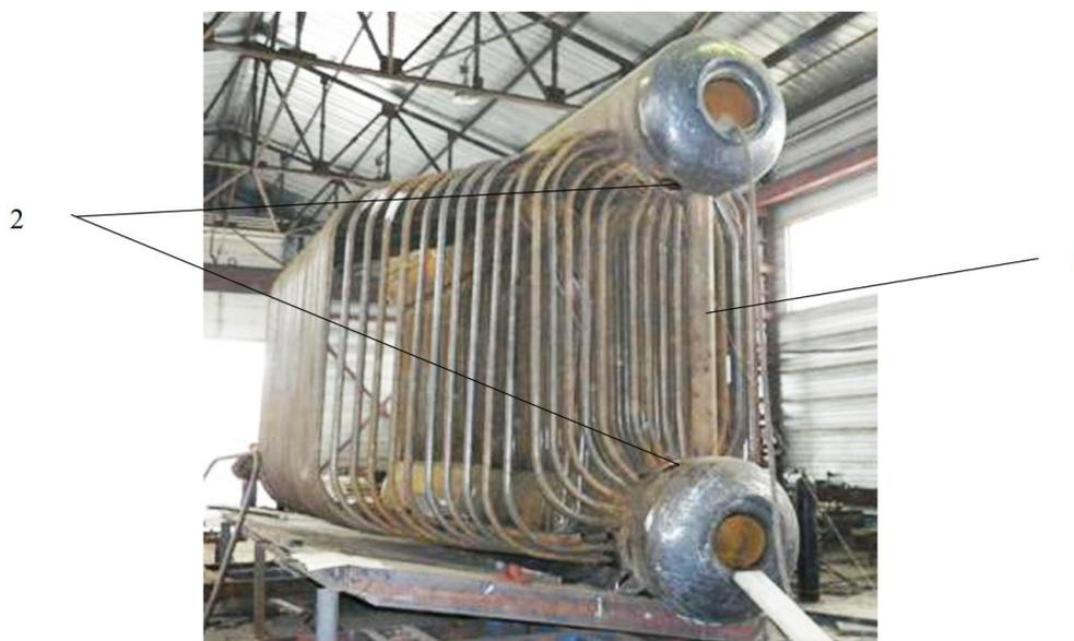
Рисунок 2.12 – Вид трубной системы котла производительностью 16 т/час со стороны солевого отсека
