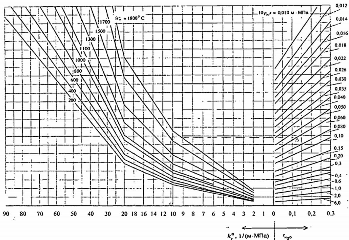
Рисунок 4.4 – Коэффициент поглощения лучей газовой фазой продуктов сгорания
